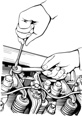
Рис. 16. Отвертывание контргайки регулировочного винта
